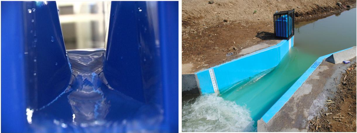
FIGURE 3.4 – Exemple de venturi ou "Parshall flume"
