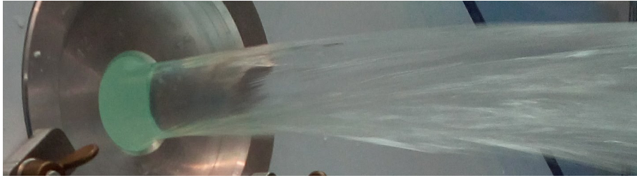
FIGURE 7.2 – Visualisation de la contraction du jet à la sortie d'un orifice.
